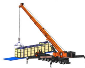
长边立式吊车卸货示意图
