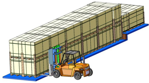
短边立式叉车卸货示意图
