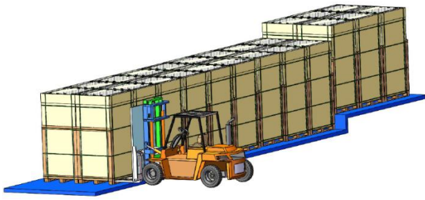
长边立式叉车卸货示意图
